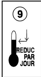
Ce paramètre permet d'activer ou non la rampe et de déterminer la valeur de celle-ci. Lorsque la rampe est active, la consigne principale est automatiquement diminuée de la valeur programmée par période de 24 heures.
