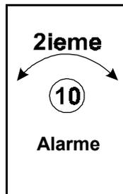
Ce paramètre établit la température en dessous de la consigne principale que la pièce peut atteindre avant que l'alarme soit signalée. Lorsqu'une alarme basse température arrive, un interrupteur d'alarme est activé et le voyant (DEL) de l'alarme sur le ECS 2M s'allume.
