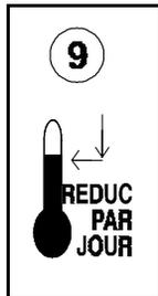
Ce paramètre permet d'activer ou non la rampe et de déterminer la valeur de celle-ci. Lorsque la rampe est active, la consigne principale est automatiquement diminuée de la valeur programmée par 24 heures.
