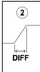
L'ajustement du différentiel du ventilateur 1 établit la température à laquelle le ventilateur 1 rencontrera sa vitesse maximale. Cette valeur est la **différence** de température à partir de la consigne principale.
