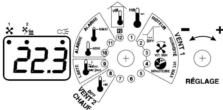
Le panneau avant du ECS 2M montré ci-haut offre un afficheur et deux boutons servant à la sélection et à l'ajustement des paramètres.
