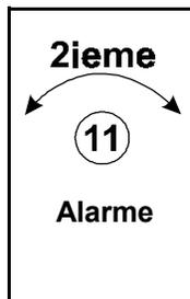
Ce paramètre établit la température en dessous de la consigne principale que la pièce peut atteindre avant que l'alarme soit signalée. Lorsqu'une alarme haute température arrive, un interrupteur d'alarme est activé et le voyant (DEL) de l'alarme sur le ECS 2M s'allume.
