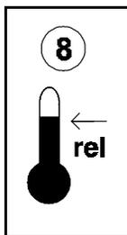
Lorsque le ECS 2M contrôle une chaufferette, la consigne relative est la température à atteindre en dessous de la consigne principale pour actionner la chaufferette.
