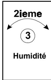
Ce paramètre établit la vitesse minimale du ventilateur 1 lorsque le niveau d'humidité relative de la pièce dépasse le niveau d'humidité relative initialisé. La vitesse initialisée pour l'humidité est normalement plus grande que la vitesse initialisée pour la température. Cette valeur est entrée comme un pourcentage de la vitesse maximale.
