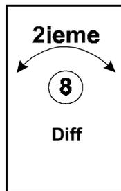
Lorsque le ECS est configuré pour une chaufferette, cette valeur représente l'augmentation de température à atteindre avant d'arrêter la chaufferette. La chaufferette commence à chauffer à la température relative initialisé par le paramètre (8) du mode primaire et s'arrêtera lorsque la température aura augmenté de la valeur initialisé par ce paramètre.
