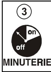
Le ventilateur 1 fonctionne à vitesse minimale et selon cette minuterie (vitesse initialisée en sélectionnant la position (2) du bouton de sélection) tant et aussi longtemps que la consigne principale n'est pas atteinte. Le temps de cycle du ventilateur 1 initialise le rapport entre le temps où le ventilateur fonctionne à la vitesse minimale et le temps qu'il est arrêté. Le temps où le ventilateur fonctionne à la vitesse minimale est entré en pourcentage de la période de **3 minutes**.
