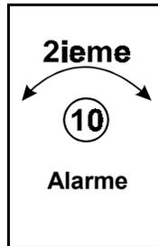
Ce paramètre établit la température en dessous de la consigne principale que la pièce peut atteindre avant que l'alarme soit signalée. Lorsqu'une alarme basse température arrive, un interrupteur d'alarme est activé et le voyant (DEL) de l'alarme sur le ECS 5M s'allume.
