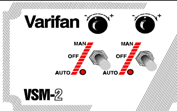
La façade du VSM-2 possède 2 interrupteurs à trois positions, 2 potentiomètres d'ajustement de vitesse et 2 DELs d'état. L'interrupteur de gauche contrôle le ventilateur 1, et celui de droite contrôle le ventilateur 2. Les potentiomètres de vitesse sont utilisés pour contrôler la vitesse des ventilateurs en mode manuel.
